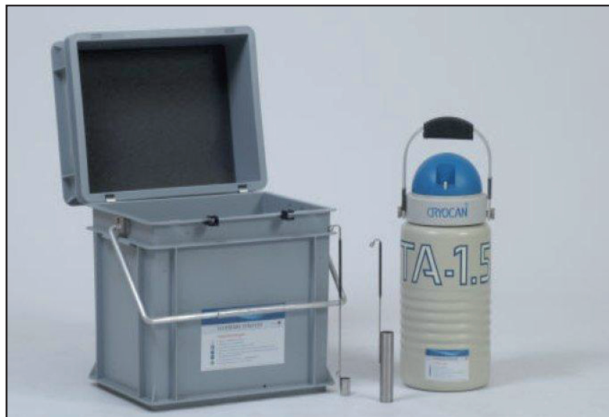
Crycare systeem bestaande uit transportbox, dipper, canister en cryovat
